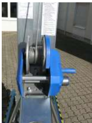
Correct opwickelen van de staalkabel op de draadtrommel
